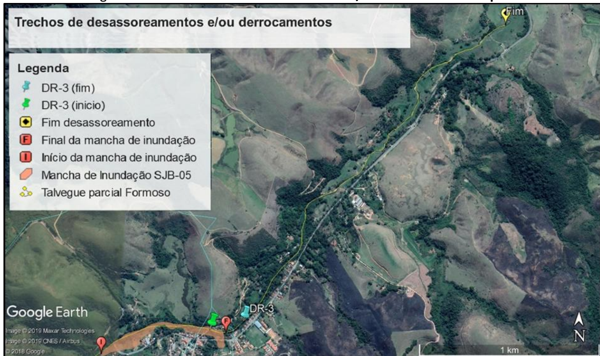
Figura 30 - Trechos a serem desassoreados e/ou derrocados ou limpos.
